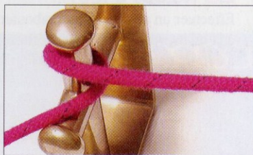
Tour mort simple : frein évitant à un cordage de filer.
