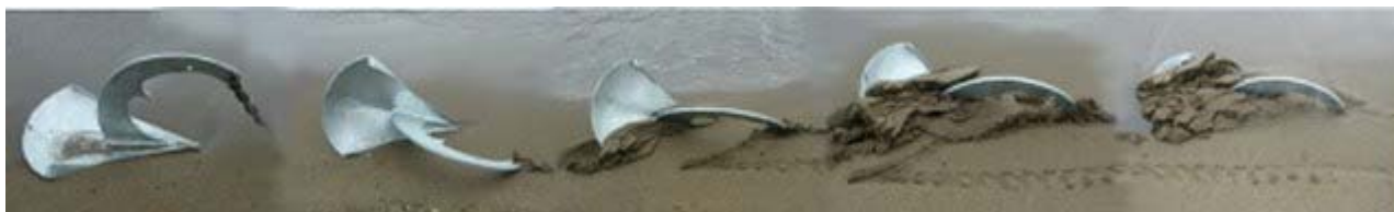
Phases d'enfouissement d'une ancre Océane
